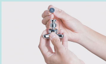
④コマの先にあるナットを外し、新しいパッキンと取り替えます。そのとき、ナットを元通りによく締め付けてください。（パッキンは日用品店で販売しています。）
