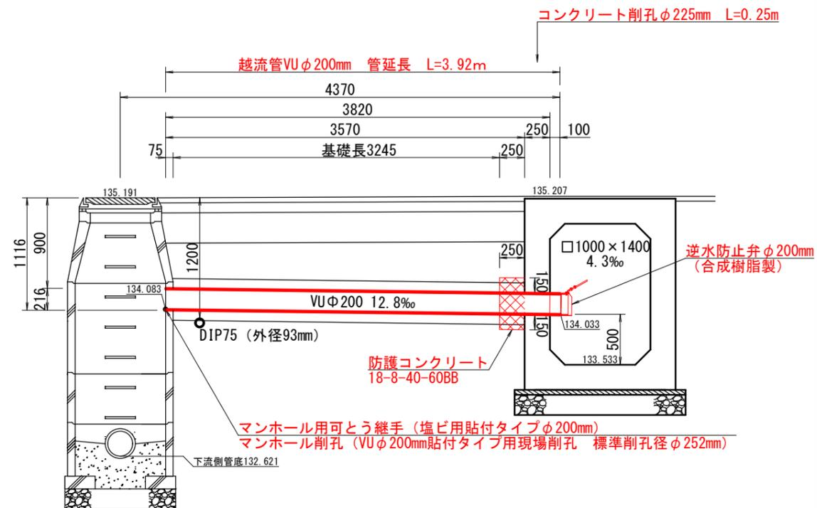
管布設断面図 S=1:25
