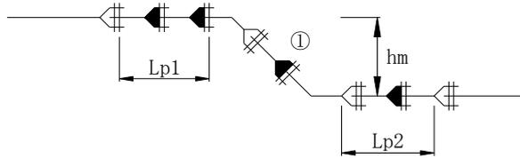
**備考** 土被りはLp1側を示す。なお表中の直結とは、45°曲管で曲管間の切管①がない場合を示す。また、水平Sベンド部は、左右ともLp1を確保すればよい。
