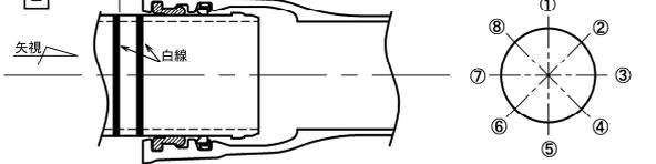
**3 P-Link (締め付けトルク: 100N・m)**
